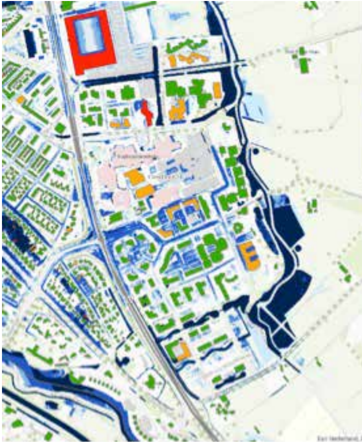
Figuur 4. Wateroverlast bij T=100 (67 mm in één uur tijd)
